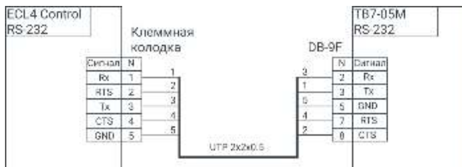
Рис.22. Схема подключения тепловычислителя ТВ7 к ECL4 Control 361 Plus Ethernet.
